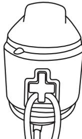
Рис. 11. Крепление кабеля удлинителя
