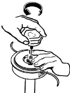
Рис. 19. Закручивание винта крепления триммерной головки
