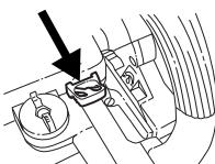
**Топливный насос:** Сожмите несколько раз резиновую грушу топливного насоса пока в нее
