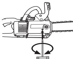
Цепь считается натянутой правильно, если она свободно проворачивается рукой. После этого , удерживая носок пильного полотна в верхнем положении, затяните гайки крепления пильного полотна универсальным ключом.
