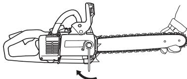
При установке новой цепи следует часто проверять ее натяжение , пока цепь не приработается. Регулярно проверяйте натяжение цепи. Регулярно проверяйте натяжение цепи. Правильно натянутая цепь обеспечивает высокое качество пиления и дольше служит.
