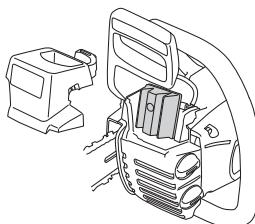
Для более тщательной чистки фильтр следует помыть в воде с мылом.
