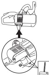
В некоторых глушителях предусмотрен специальный искрогаситель. Если ваша машина оборудована таким глушителем, сетку фильтра следует чистить раз в неделю. Наилучшие пользоваться стальной щеткой. Забитая решетка приводит к работе с горячим
