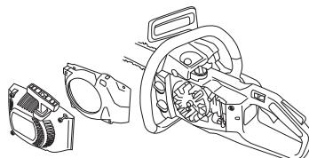
Производите очистку системы охлаждения щеткой раз в неделю или чаще, если этого требуют условия работы. Загрязненная или засоренная система охлаждения может привести к перегреву машины и вызвать повреждение поршня и цилиндра.
