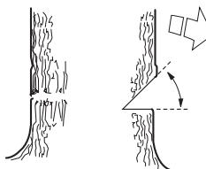
Линия, на которой сходятся два этих пропила, называется направляющей линией. Эта линия должна быть строго горизонтальной и составлять прямой угол (90 градусов) к предполагаемому направлению падения.
