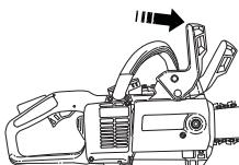
**Зажигание:** Перевести выключатель зажигания в положение включения.
