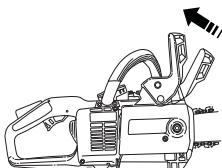
Отвинтите гайки крепления пильного полотна и снимите крышку муфты сцепления (тормоза цепи). Снимите транспортировочное кольцо (A).
