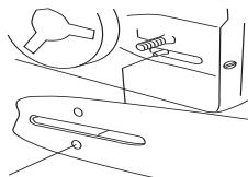
Для этого поверните винт механизма регулировки цепи по часовой стрелке. Цепь следует натягивать до тех пор, пока она не будет плотно прилегать к нижней стороне пильного полотна.
