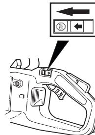
двигатель останавливается, когда контакт остановки будет передвинут в положение остановки.
