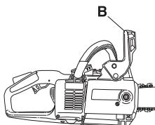
Сдвиньте ручку тормоза вперед и назад, удостоверьтесь, что она перемещается свободно, и надежно фиксируется на крышке сцепления.
