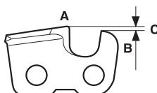
**ПРЕДУПРЕЖДЕНИЕ!** Чрезмерно большое ограничение глубины врезания увеличивает риск отдачи пильной цепи!
