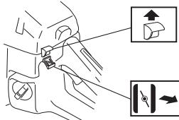
Если машина оборудована декомпрессионным клапаном (A): Его необходимо нажать, чтобы уменьшить давление в цилиндре и облегчить запуск машины. При запуске машины всегда пользуйтесь декомпрессионным клапаном.
