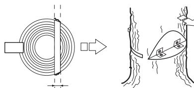
Возможность влияния на направление падения будет полностью утрачена, если полоса разлома слишком узкая или пропилована направляющий и основной пропили плохо размещены.
