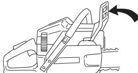
Отвинтите гайки крепления пильного полотна и снимите крышку муфты сцепления (тормоза цепи). Снимите транспортировочное кольцо (A).
