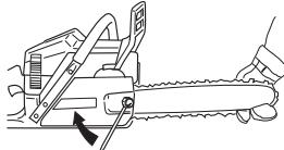
При установки новой цепи следует часто проверять ее натяжение , пока цепь не приработается. Регулярно проверяйте натяжение цепи. Регулярно проверяйте натяжение цепи. Правильно натянутая цепь обеспечивает высокое качество пилиния и дольше служит.
