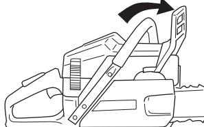
**Зажигание; подсос:** Установите рычаг подсоса в положение подсоса. Выключатель при этом должен автоматически перейти в положение пуска.
