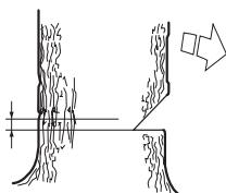
Вставьте зубчатый упор (если установлен) сзади надреза. Работайте на полном газу и вводите пильное полотно в ствол дерева постепенно, плавным движением. Следите за тем, чтобы дерево не начало перемещаться в направлении, противоположном предполагемому направлению падения. Как
