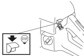
двигатель останавливается, когда контакт остановки будет передвинут в положение остановки.
