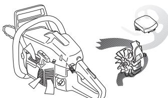
**ВАЖНО!** Для осуществления метода центробежной очистки нужно постоянно выполнять техническое обслуживание и уход за системой. Необходимо чистить воздухозаборник стартера, лопасти вентилятора на маховике, пространство вокруг маховика, входного коллектора и карбюратора.
