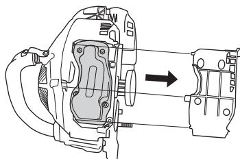
Открутите болты и гайки. Демонтируйте и проверьте глушитель выхлопной системы.
