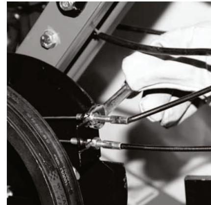
Со временем тросы привода могут растянуться. Для их регулировки необходимо расконтрить гайки и добиться оптимального натяжения тросов.
