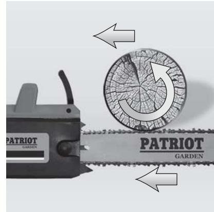
Можно начать распиловку снизу, для этого распишите бревно примерно на четверть диаметра бревна, а затем закончите распиловку сверху. Помните, если бревно не закреплено, то при начале распиловки оно может сдвинуться в сторону противоположную движению цепи и травмировать.
