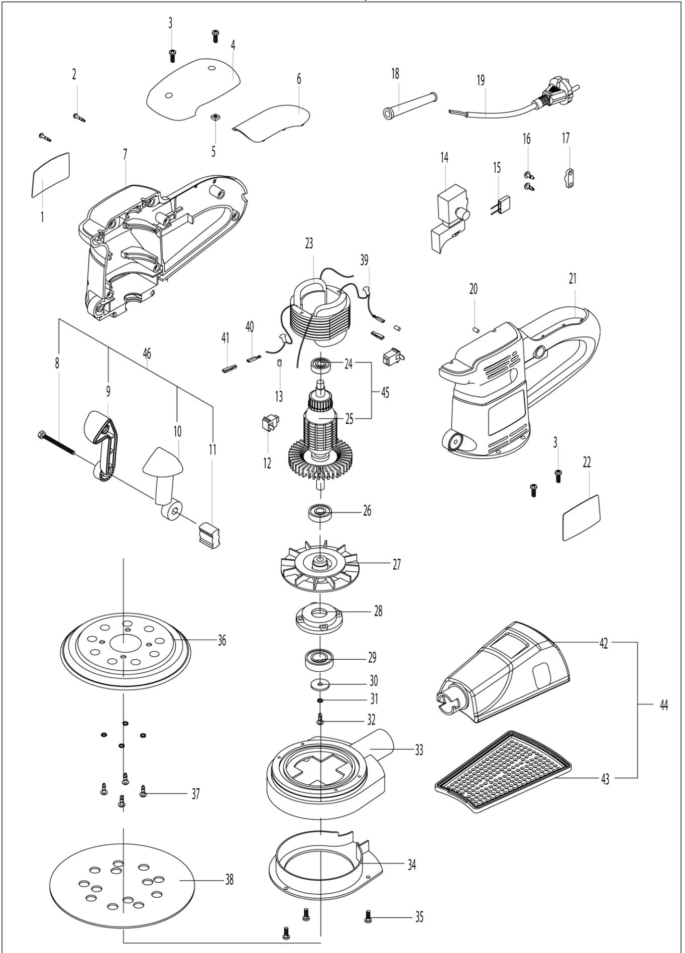
Шлифмашина эксцентриковая **МШЭ-450/150Э** (Арт. 50302)
