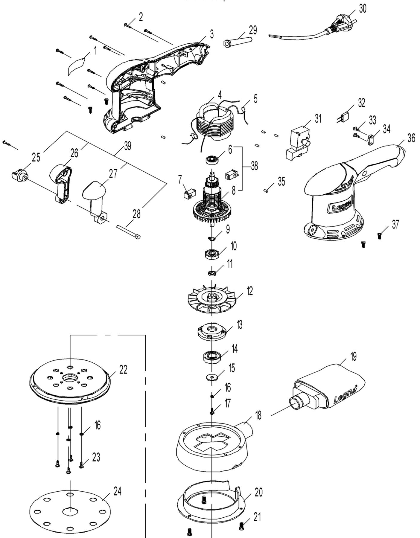
Шлифмашина эксцентриковая **МШЭ-450/150Э** (Арт. 50302)
