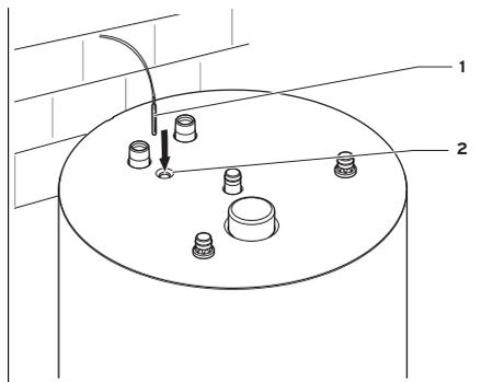
1. Выполните монтаж датчика температуры накопителя (1), введя его до упора в погружную гильзу (2).
