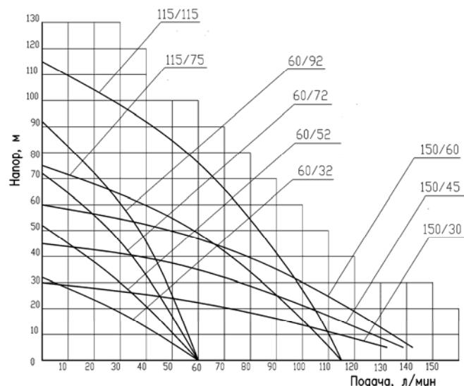
Заявленные характеристики насосов были получены при испытании с напорной магистралью согласно модели насоса и напряжением 220 вольт.
