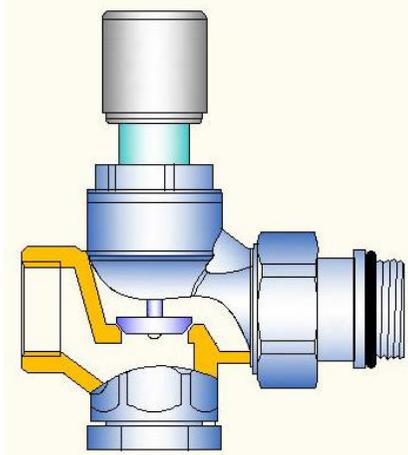
Клапан имеет два входа (прямой и угловой), что дает возможность устанавливать его как на прямых, так и угловых участках трубопровода. Неиспользуемый вход закрывается резьбовой пробкой или используется для присоединения дополнительной арматуры или КиП. Наличие самоуплотняющегося полусгона на выходном патрубке клапана позволяет легко монтировать и демонтировать изделие в системе.
