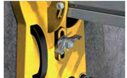
Узел крепления установки для алмазного сверления
