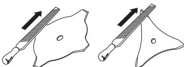
напильником. Пользуйтесь круглым напильником на 5,5 мм с держателем.
