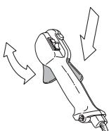
См. указания в разделе Запуск. Включите машину и полностью откройте дроссель. Отпустите рычаг дросселя и удостоверьтесь, что режущее оборудование останавливается и остается неподвижным. Если после постановки дросселя в положение холостого хода режущие оборудование продолжает вращаться, следует проверить регулировку холостого хода карбюратора. См. указания в разделе Техническое обслуживание.
