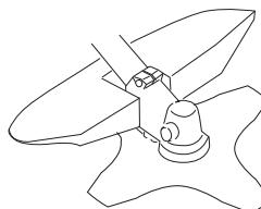
Проверьте, чтобы защита не была повреждена и чтобы на ней не было трещин. Замените защиту, если она была подвергнута удару или если на ней есть трещины.
