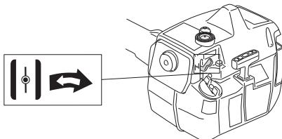
Топливный насос: Сожмите несколько раз резиновую грушу топливного насоса пока в нее не начнет поступать топливо. Грушу нет необходимости заполнять полностью.
