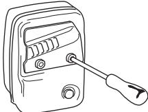
Если глушитель на вашей машине дополнительно оборудован искрогасящим фильтром, его следует регулярно прочищать. Забившийся фильтр может вызвать перегрев двигателя и привести к серьезным повреждениям двигателя.
