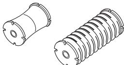
Регулярно проверяйте, чтобы на виброгасящих элементах не было трещин или деформаций. Проверьте, чтобы амортизатор был в целости и хорошо закреплен.
