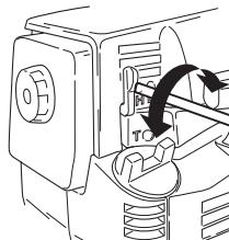
Заметьте, что двигатель при регулировке иглы высоких оборотов H должен работать без нагрузки. Снимите, поэтому, перед регулировкой иглы высоких H оборотов режущее оборудование, гайку, опорный фланец и подающий патрон.
