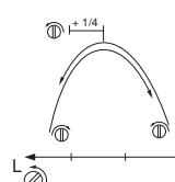
**ВНИМАНИЕ!** Если режущее оборудование вращается или подвижно при работе на холостых оборотах, винт T следует вращать против часовой стрелки до тех пор, пока режущее оборудование не остановится.
