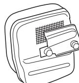
Если на вашем инструменте стоит глушитель такого типа, то сетку следует очищать не реже одного раза в неделю. На глушителях с катализатором, такую очистку достаточно производить раз в месяц. При возникновении повреждений на сетке ее следует заменить. Если сетка часто бывает засорена, значит
