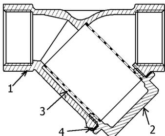
Фильтр состоит из корпуса 1, пробки 2, фильтроэлемента 3 и прокладки 4. Корпус и пробка фильтров диаметром условного прохода до 2" выполнены из горячепрессованной, никелированной латуни марки CW617N. Между пробкой и корпусом располагается уплотнительная прокладка из тефлона. В корпус помещен фильтроэлемент из нержавеющей стали AISI 316 (толщина проволоки 0,3мм). Пробка фильтра имеет отверстие (ушко) для пломбировки. Направление потока указано стрелкой на корпусе фильтра.
