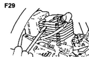
Засорение опилками и пылью между ребрами цилиндра приведет к перегреву двигателя. Периодически проверяйте и очищайте ребра цилиндра после снятия воздушного фильтра и крышки цилиндра.
