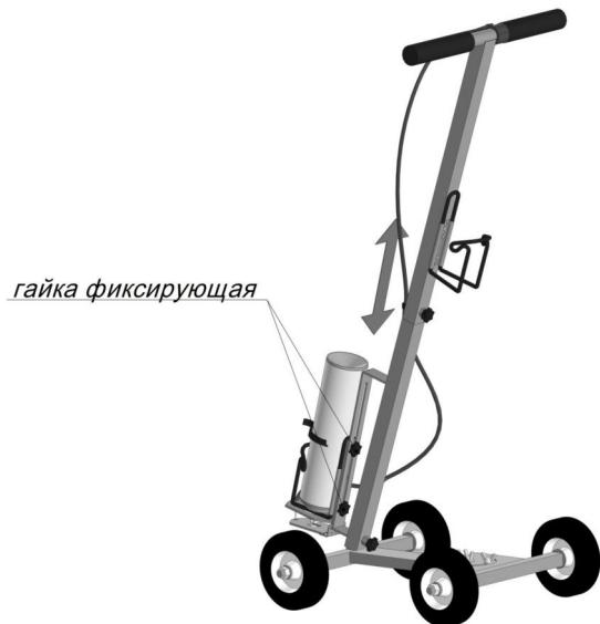
Для увеличения ширины полосы механизма фиксации баллона переместите вверх, для уменьшения ширины - опустите вниз. Нажмите рычаг на руле, передвиньте тележку вперёд и убедитесь, что наносится полоса нужной ширины.
