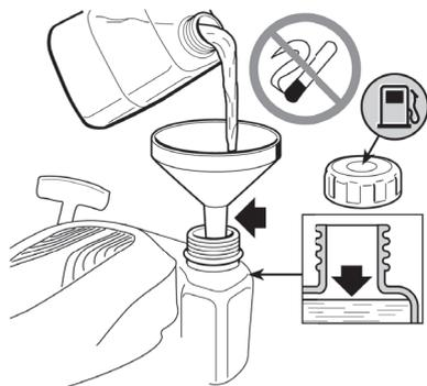
Если топливо пролилось, уберите газонокосилку от места разлива топлива. Избегайте источников образования искры, пока пары бензина полностью не выветрятся. Протрите насухо пролитое масло или топливо. Не храните топливо и не заполняйте бензобак вблизи открытого пламени.
